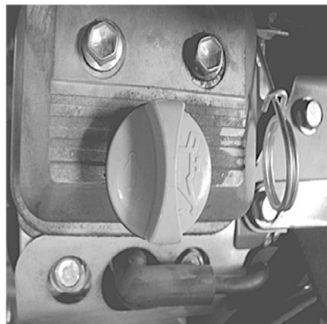
الشكل 10.6: إجراءات فحص مستوى الزيت
