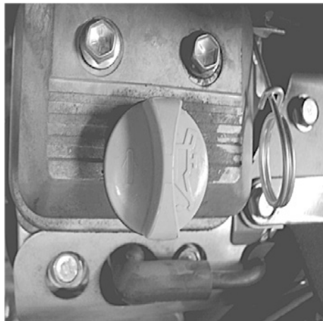
الشكل 10.6: إجراءات فحص مستوى الزيت
