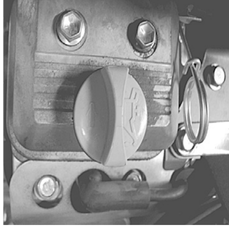
Figura 10.6: Procedimento para verificar o nível de óleo
